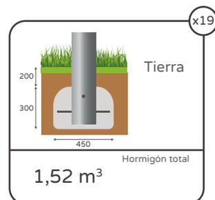
\*Una vez realizada la cimentación de los elementos, estas zapatas tienen que ser accesibles para revisiones periódicas de inspección y mantenimiento.
